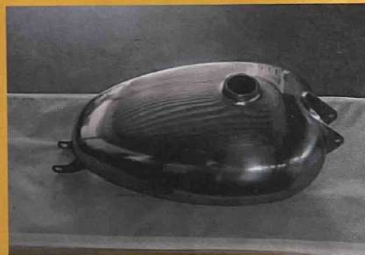
Dopo la scromatura, il battilama ha individuato e tolto tutte le imperfezioni e ammaccature e quindi l'ha lucidato
