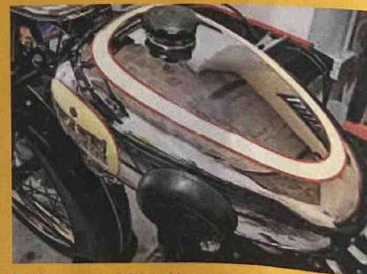
Eccolo ricromato: è finito ed è stato rimontato sulla moto
